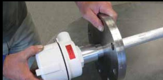
*El rotativo puede entonces ser montado atornillandolo en el cople o plato de montaje.*
